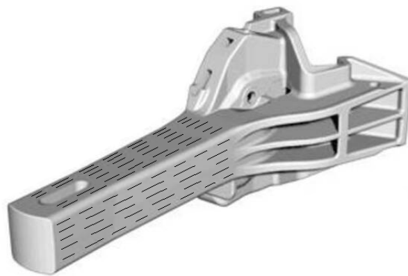
Рис. 8.12. Контроль поверхностей хвостовика автосцепки
