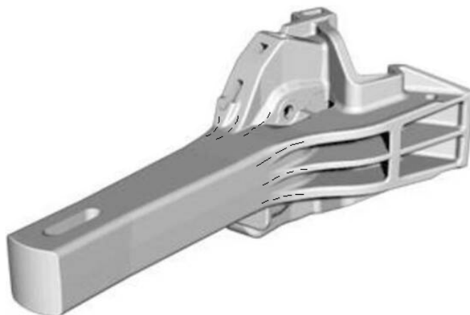
Рис. 8.14. Контроль переходов от хвостовика к головной части
