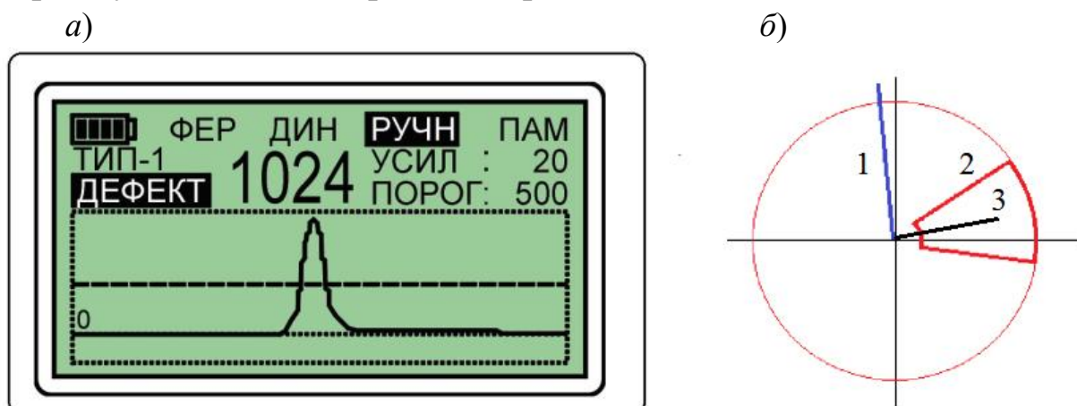
Рис. 6.2. Представление информации о дефекте на временной развертке (а) и на комплексной плоскости (б):
